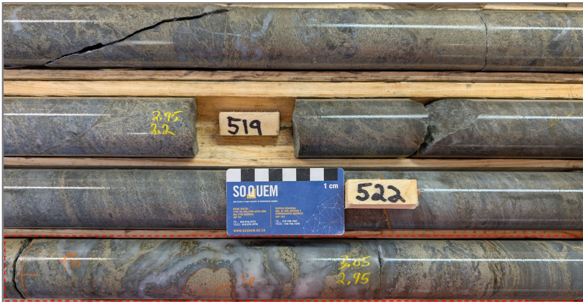
Figure 4. Indice Détour-Selbaie : Exemple de minéralisation semi-massive à sphalérite (mielleuse/beige) et pyrite entre 515,1 m et 538,5 m du sondage 1338-25-087. Entre autres, l'échantillon C1853487 (encadré rouge) rapporte 21,20 % Zn, 0,82 % Pb, 0,14 % Cu et 165,0 g/t Ag sur 0,6 m.
