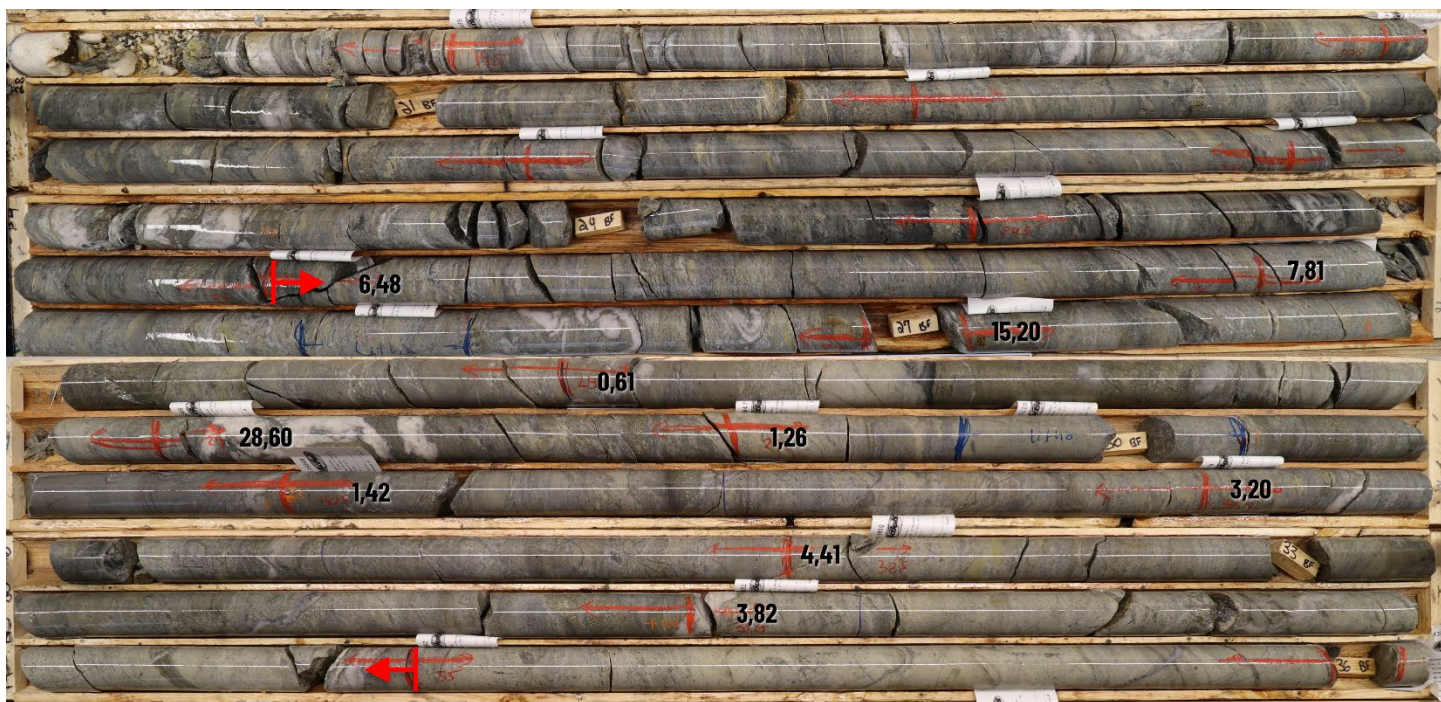
Figure 6. Minéralisation aurifère du secteur Brèche de Lespérance : 6,33 g/t Au sur 10,0 m (sondage 1435-25-028)
