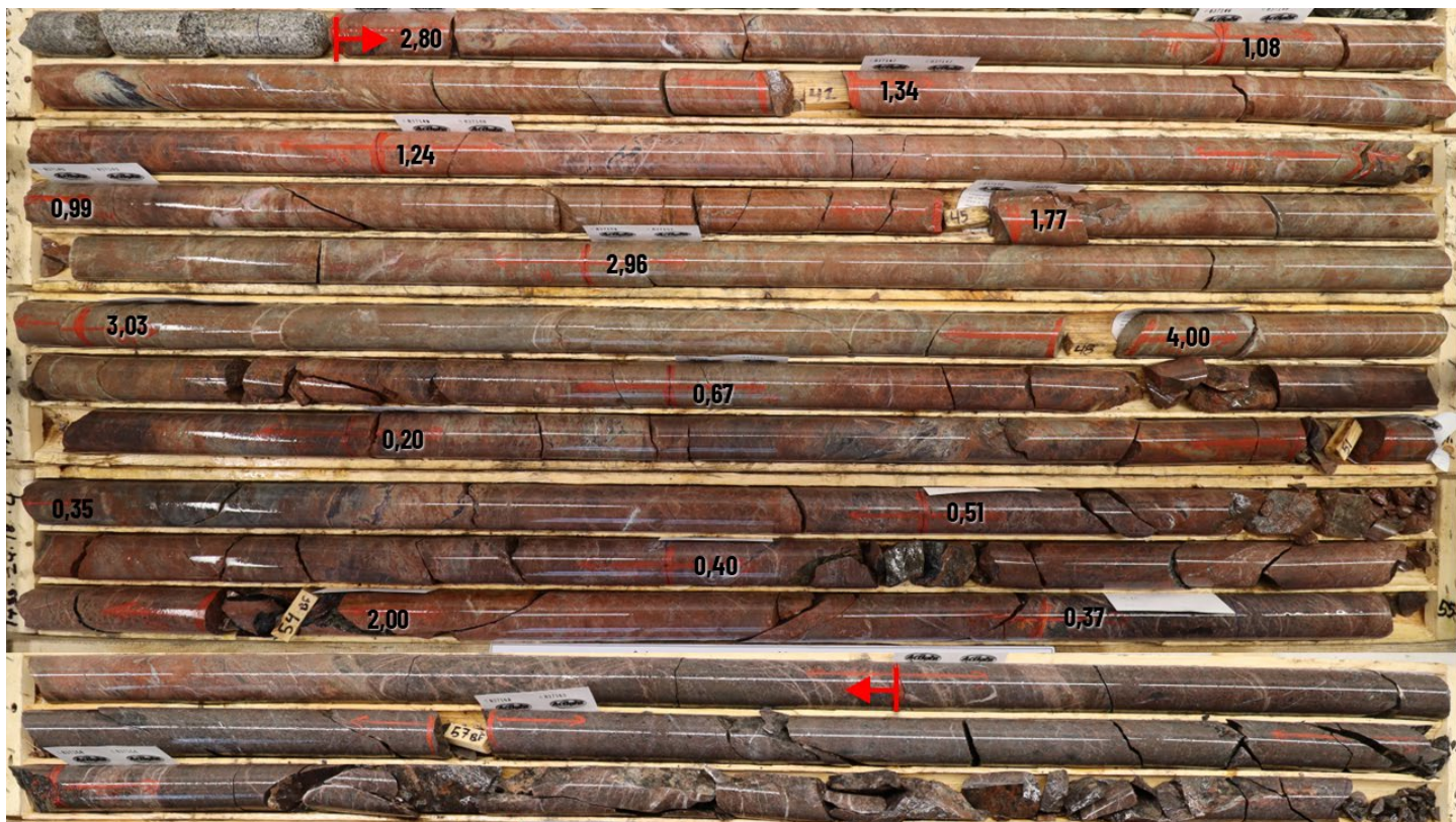
Figure 3. Intervalle à haute teneur du secteur Boyvinet : 1,46 g/t Au sur 16 m (sondage 1435-24-018). La zone minéralisée débute immédiatement après le mort-terrain. Les résultats aurifères (g/t) de chaque échantillon sont indiqués en noir et positionnés en début d'intervalle.
